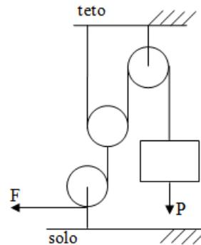
Assinale a alternativa que indica corretamente o módulo da força ( $F$ ) necessária para manter um objeto sujeito a uma força-peso de módulo igual a “ $P$ ” parado acima do solo.
